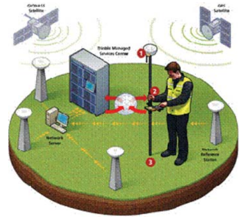
Şekil 9 - CORS yardımıyla real time GPS ölçümü
