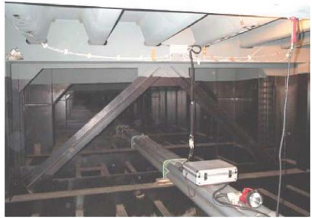
Şekil 7 - Birim deformasyon ölçer ve birim deformasyonu kontrol eden alet kullanılarak OÇT'de gerilme ölçümü ile ilgili örnek
