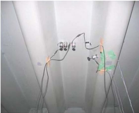
Şekil 7 - Birim deformasyon ölçer ve birim deformasyonu kontrol eden alet kullanılarak OÇT'de gerilme ölçümü ile ilgili örnek
